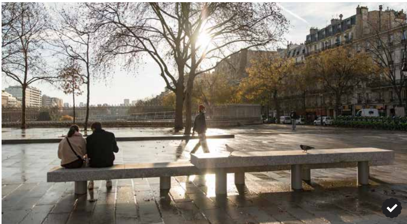
BANCS EN BORDURES DE TROTTOIR RECYCLÉES AVEC FONCTION ANTI-BÉLIER PLACE DE LA BASTILLE - 4°, 11°, 12°
